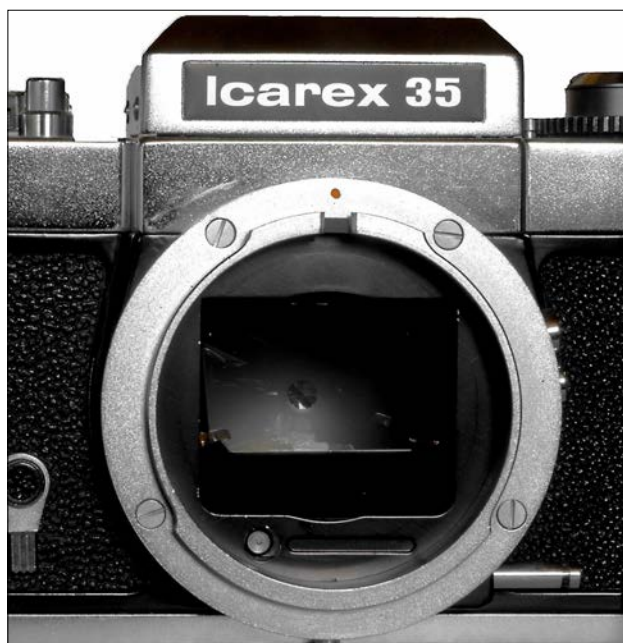
Objektiverne skiftes i en stikbajonetfatning.
