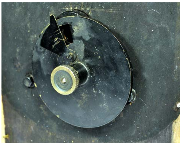
Lukkeren. Læg mærke til den lille klap, der kan lukke mere eller mindre af for hullet.
