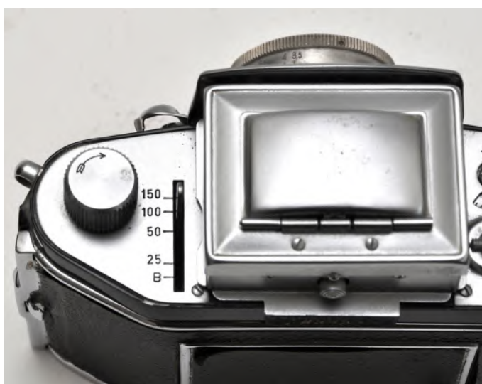
Toppen med palen for indstilling af lukkertiden.
