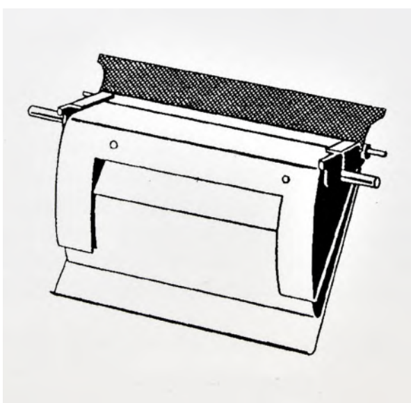
Klapplukkeren set forfra bag bajonetten. Og set bagfra. Og tegning af den effektive klapplukker,
