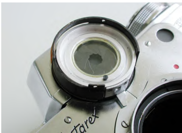
Det runde hus omkring belysningsmålerens øje på Contarex.
