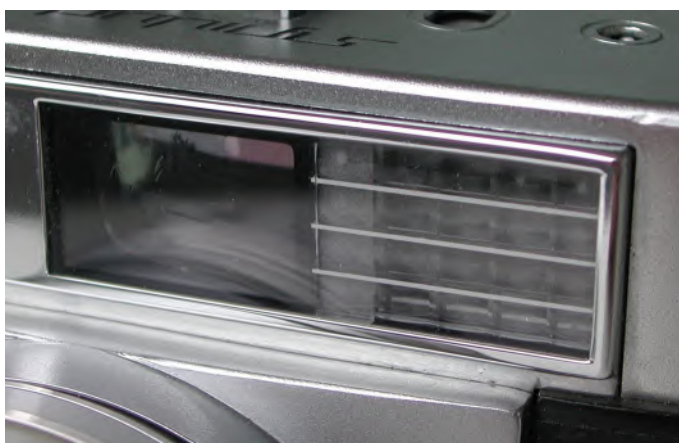
Søgeren med "min" bikage-formede rude foran belysningsmåleren.
