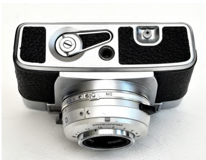
Håndsvinget til returspolingen ligger beskyttet i kameraets bunddæksel.
