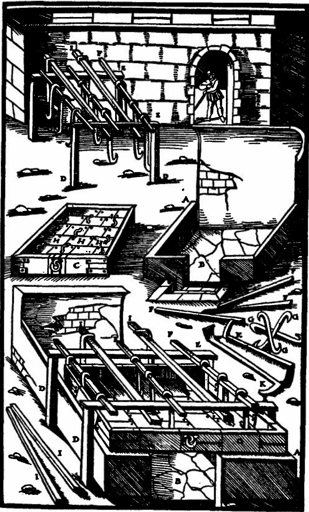
Fig. 2. Saltudvinding i Lüneburg, efter Agricola: De Re Metallica (1912-udgaven p. 551). A: fyrsted, B: indfyriingssted, C: røgfang, D og E: stolper, F: stænger, G: kroge, H: hanke på kedlen, I: stænger der holder kedlen.
