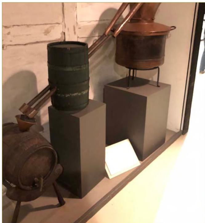
Komplet udstyr til brændevinsbrænding. Til højre kedlen med hat og piber, der leder dampene gennem svaletønden ned i tønden, hvor dråberne samles. Det Grønne Museum.
