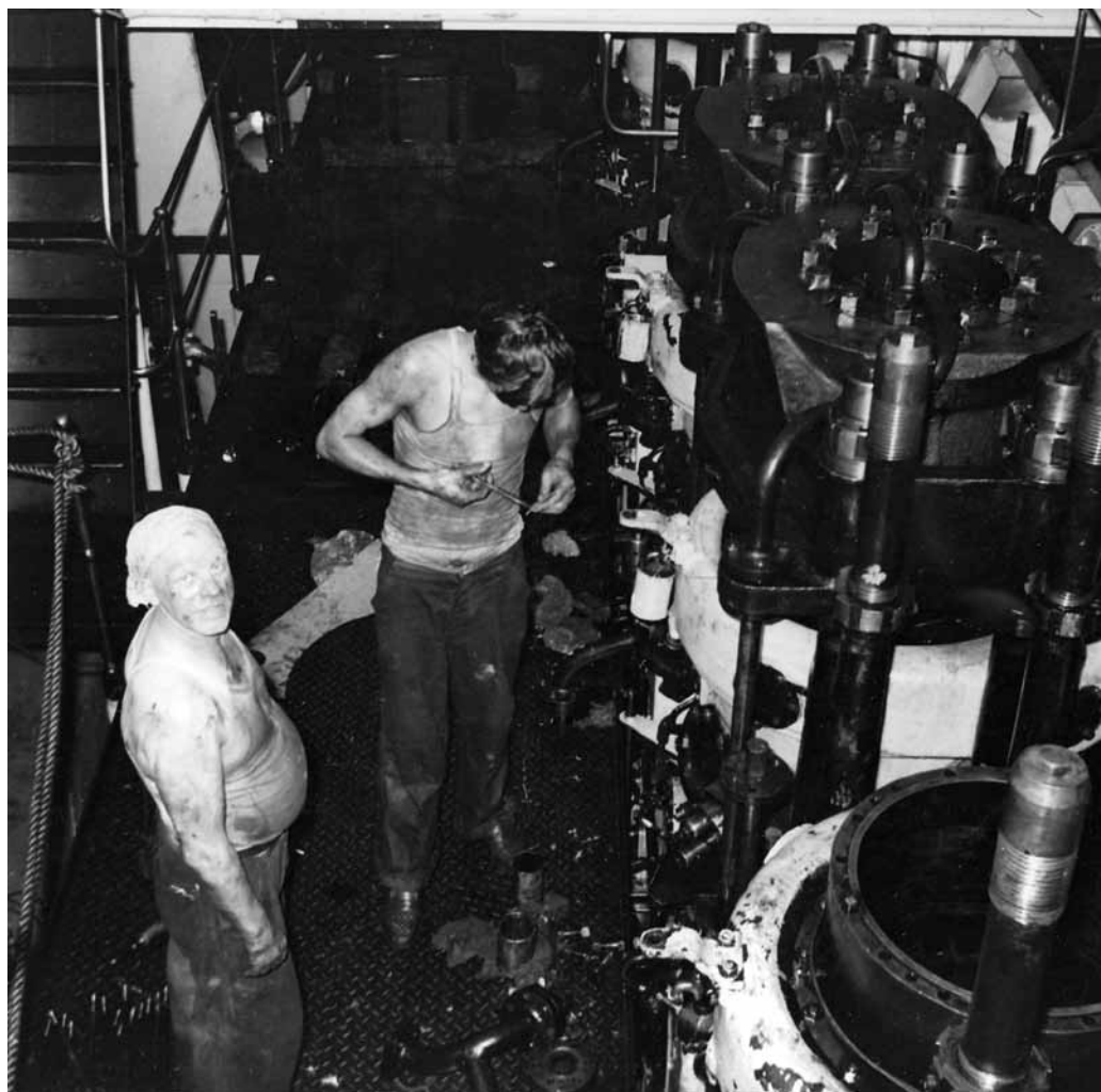
Hovedmaskinen på Malaya under reparation efter et maskinhavari i Middelhavet. (Handels- og Søfartsmuseet på Kronborg)
