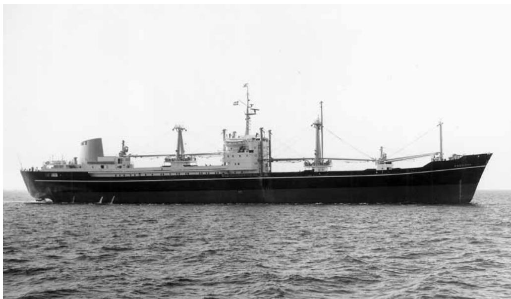
Motorskibet Andorra. Skibene i A-serien afveg en del fra hinanden. Andorra fra 1964 var et meget moderne skib med vagtfrit maskinrum, skrue med stilbare blade og hydrauliske luger. (Arkiv Nautilus Forlag)
