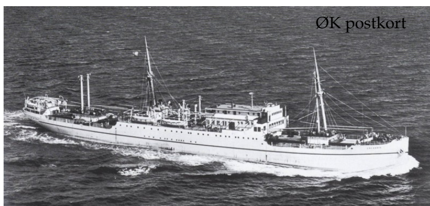
Lalandia efter ombygning fra 4 master til 2 master.
