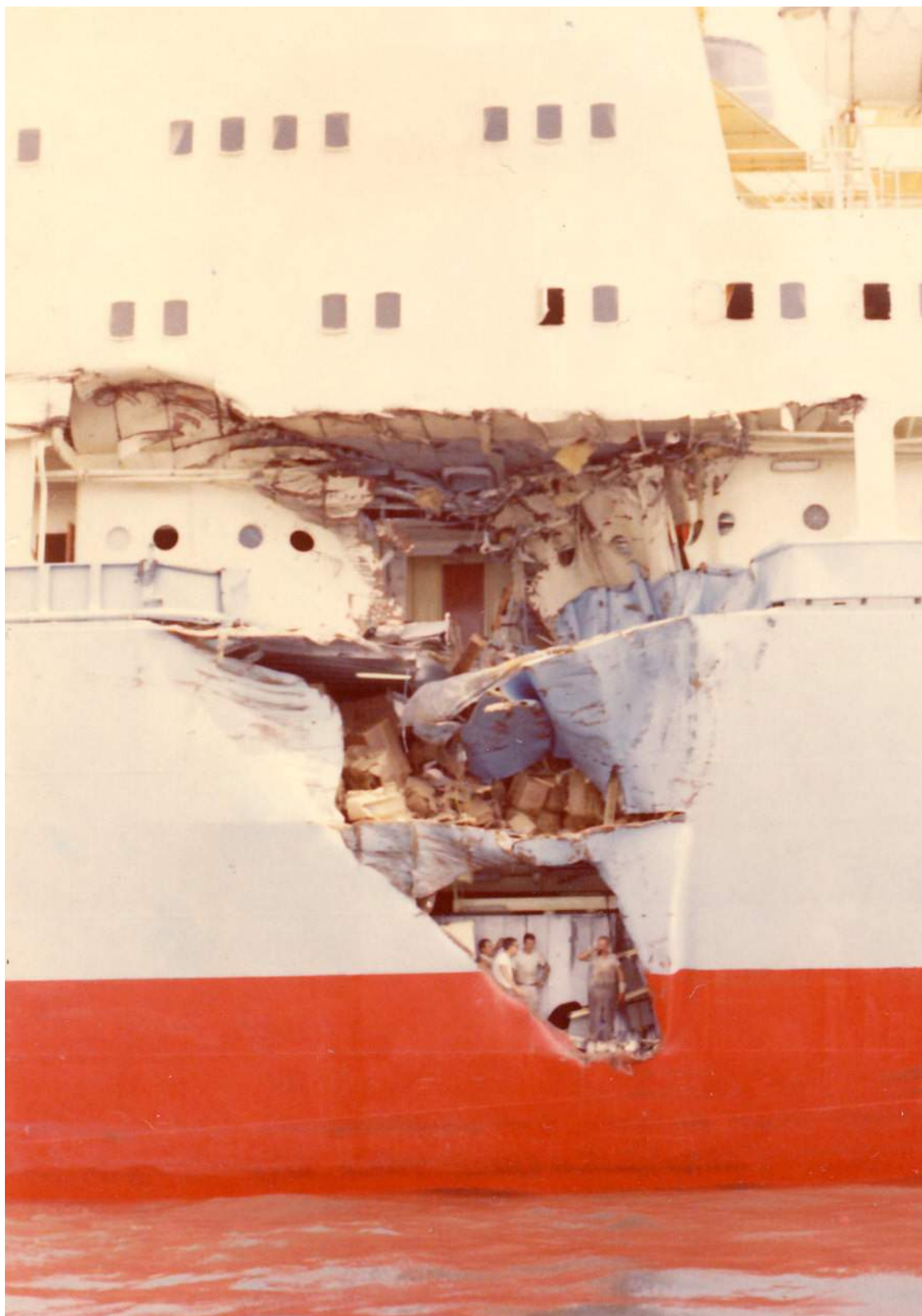
Bagbord side sfter kollisionen. Hullet var direkte ind i maskinkontrolrummet. I "det store nye vindue" ses fra venstre: elektrikeren, chiefen, 1.mester og jeg selv. Foto: Privat.
