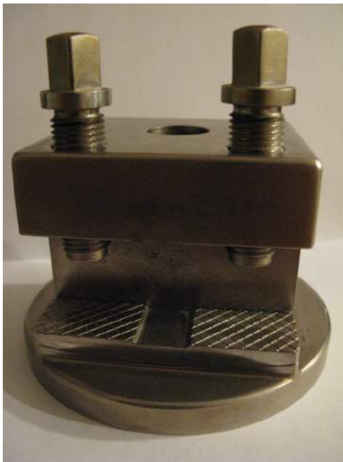
Svendestykket, en enkelt stålholder, for en drejebænk. Foto: Privat.
