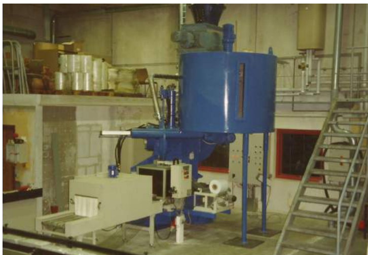
Det dobbelte automatiske kom-pakterings anlæg hos Kara. Foto: Privat.
