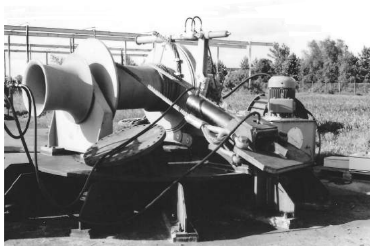
Test af bugerspil til North American Shipbuilding i USA. Spillene var med 5 ton trækraft og med 75 ton bremsekraft og skulle monteres på slæbebåde, beregnet for bugsering af de store atomubåde. Foto: Privat.
