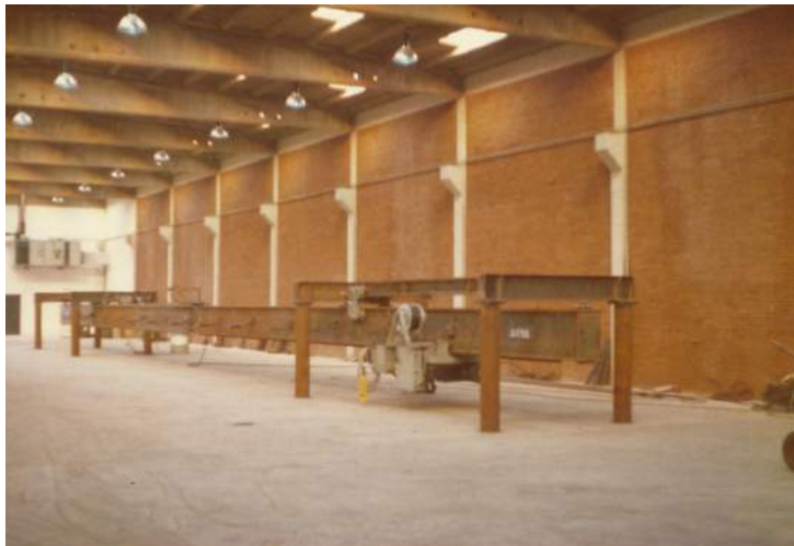
Gantrykranen ved funktionstest-opstilling i hal 3. Foto: Privat.
