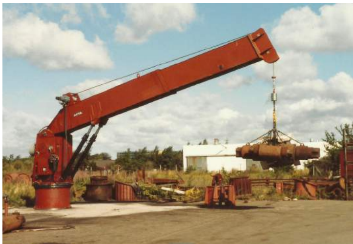
Den nye kran for Fulk al Salamah på prøvestanden på fabrikken. Foto: Privat.
