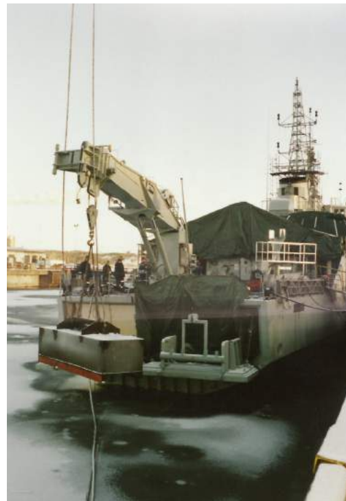
Kranen testes, men på grund af manglende stabilitet i skibet, havde en kran fat i vægten. Foto: Privat.
