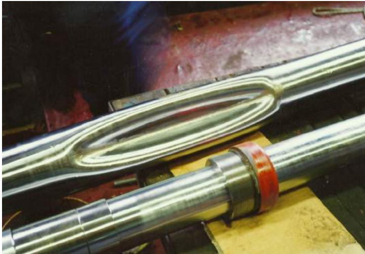
Sugningen i røret, som viste sig at komme, grundet de store arealforskelle mellem negativ og positiv siden. Der måtte så monteres en ny større sænkebremseventil. Foto: Privat.
