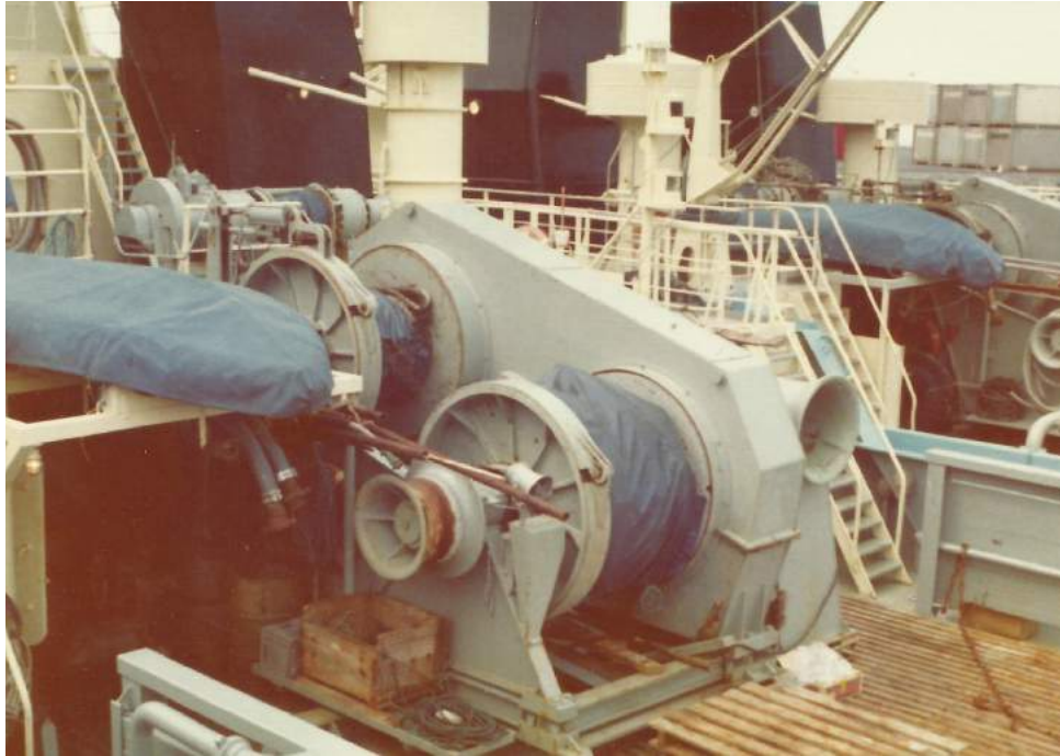
Thrige bugerspil, spillet som er af waterfall typen var drevet af en dieselmotor og blev betjent fra en mamøvrepult på åbent dæk. Foto: Privat.
