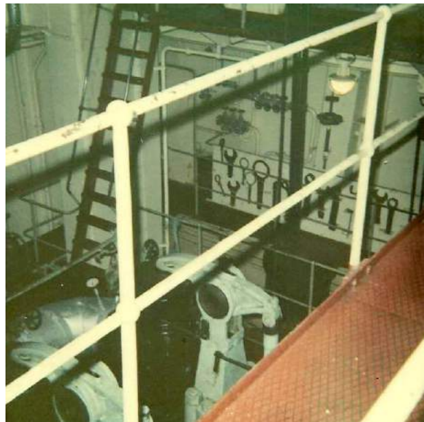
Maskintoppen med hovedmotorens udstødningsventiler og vippearme. Foto: Privat.
