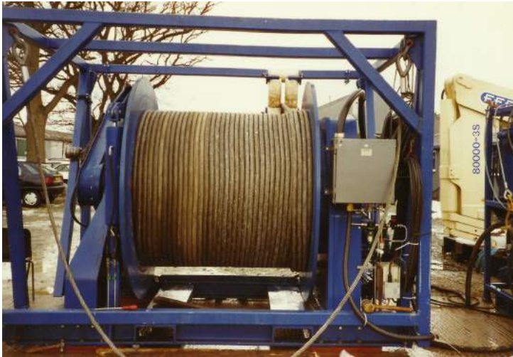
Spillet med på spolet kabel, efter den nye trinløse justering var monteret. Foto: Privat.
