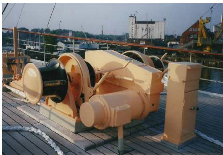
Ankerspillet: bundrammen og varpenokkerne er fra det gamle spil. Foto: Privat.
