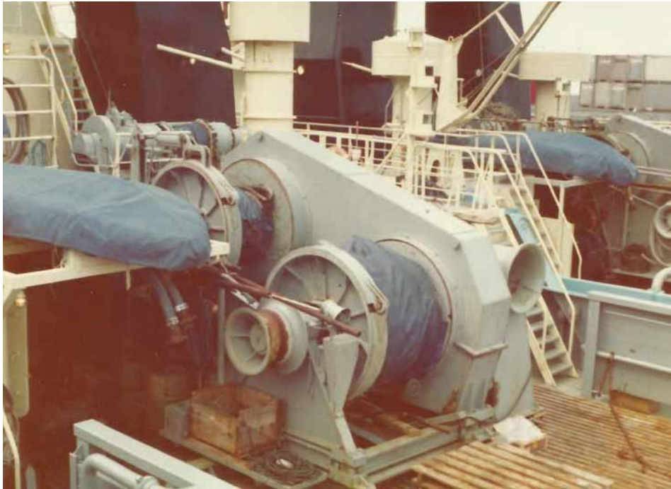
Thrige bugerspil, spillet som er af waterfall typen var drevet af en dieselmotor og blev betjent fra en manøvre pult, på åbent dæk. Foto: Privat.
