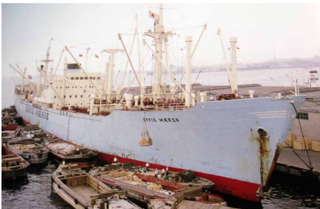
Effie Mærsk bygget i 1955 på Odense Stålskibsværft, var udrustet med lastkøleanlæg, med seks køle/ fryselastrum. I 1965 blev Effie på værft i Japan forlænget med 11 meter. Foto: A.P.Møller.
