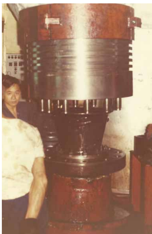
Montering af stempelhoved på stempelstang Foto: Privat.
