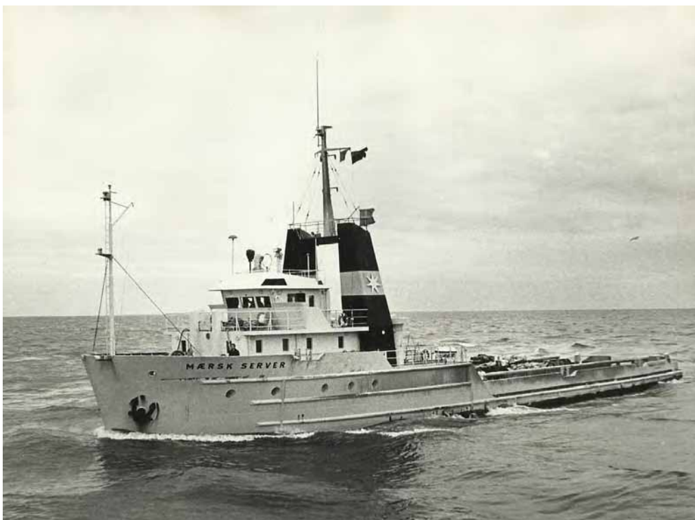
Mærsk Server Anchor Handling Tug Supply vessel. Bygget på Århus Flydedok og Maskinkompani i 1971. 757 dwt. 3800 HK og med et pæletræk på 40 tons. Foto: Privat.
