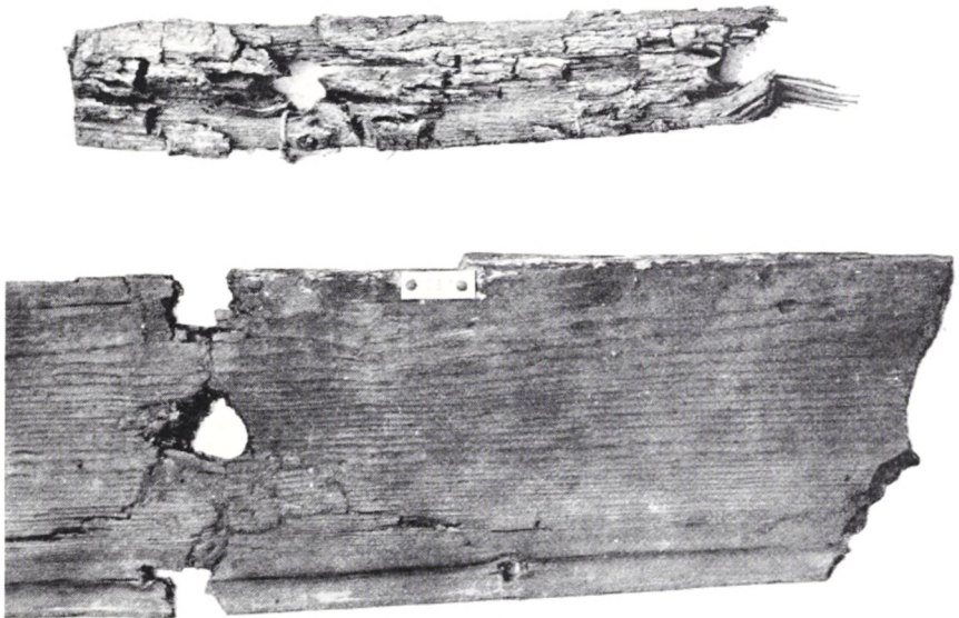
Fig. 4. To træstykker fra Skuldelev-fundet. Det øverste er overladt til at tørre af sig selv. Det nederste er konserveret efter den i artiklen beskrevne metode og har bevaret form, størrelse og udseende så at sige uændret. Det øverste er skrumpet til omtrent halvdelen af den oprindelige bredde, er revnet og smuldet til ukendelighed.
