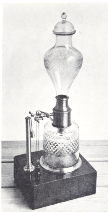
Fig. 14. Fyrtøj fremstillet i sidste halvdel af forrige århundrede på Prof. Smiths mekaniske etablissement. Kbh. Fyrtøjet har en umiskendelig ydre lighed med Fürstenbergers og Pizenbergers fyrtøjer, men forbindelsesrøret fra den øvre beholder er forlænget, så det næsten når bunden, og et stykke zink er ophængt i en krans omkring rørets nederste ende, sådan at apparatet kan fungere efter Kipp's princip. Syren trykkes tilbage op i den øvre beholder gennem røret i midten. Der er sølgelig også kun én hane, der ved et snoretræk er forbundet til et elektrofor i apparatets bund. Apparatet er forsynet med spritlampe. Danmarks tekniske museum. DTM 2268.
