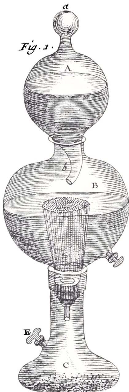
Fig. 15. Parkers apparat til sodavandsfremstilling. Gengivelse fra Sigaud de la Fond: „Essai sur differente Especies d'Air-fixe ou de Gas“, 1779, farveplanchen nederst t. v. Et eksemplar af dette apparat findes i Deutsches Museum, München.
