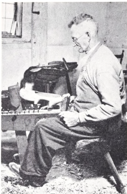
Fig. 14. Med en spånkniv finsnittes træskoens fastspændt i snitteskamlen.
