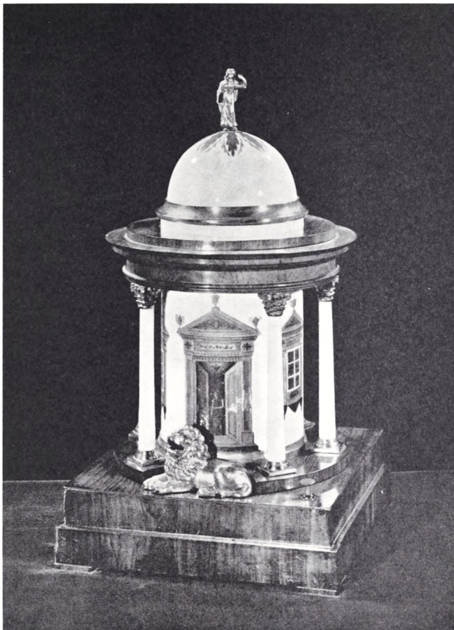
Fig. 9. Fyrtøj med brintudviklingsapparat og elektrofor, mærket C. F. Schultz, Stettin, Berliner Thor Nr. 489. Flammen udsendes gennem løvens mund. Science Museum, London. Inv. 1949-109. Science Museum fot.
