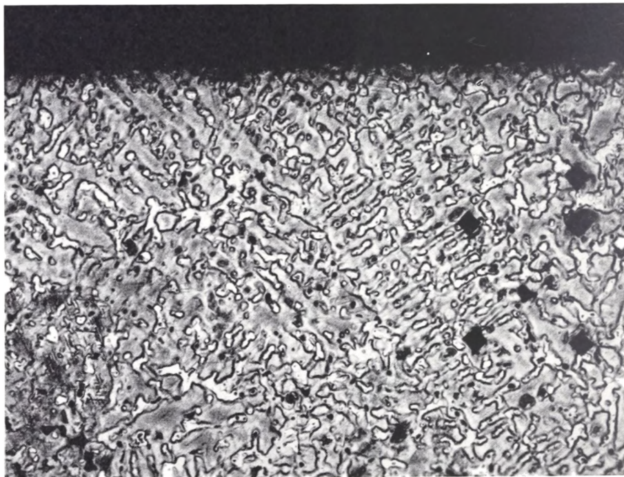
Fig. 6. Et poleret og ætset snit gennem metallet. Strukturen er klart dendritisk. De fem firkantede fordybninger i billedets højre side stammer fra opmærkningen med mikrohårdhedsmåleinstrument. (Metallaboratoriet, Danmarks Tekniske Højskole fot.) 150×.
