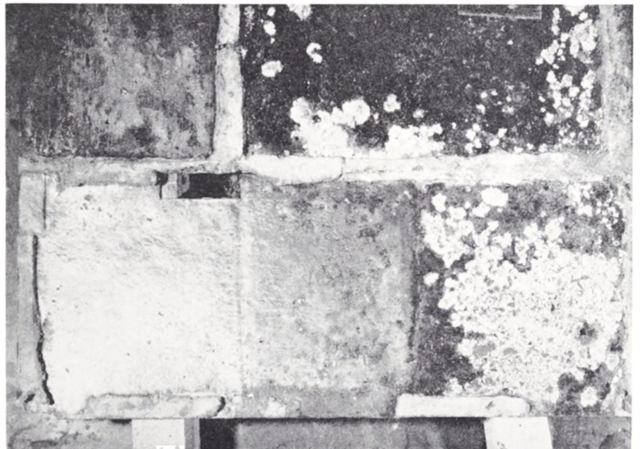
Fig. 28. Pladen under afrensning. Længst til højre et urensset parti. I midten er pladen rensset med såkaldt alkalisk Rochelle-saltopløsning. Længst til venstre er rensning tilendebragt med fortyndet svovlsyre og afbørstning med messingtrådsbørste. Pladen er endelig skyllet i destilleret vand, tørret og behandlet med Benzoetriaazol korrosionshæmmende middel.
