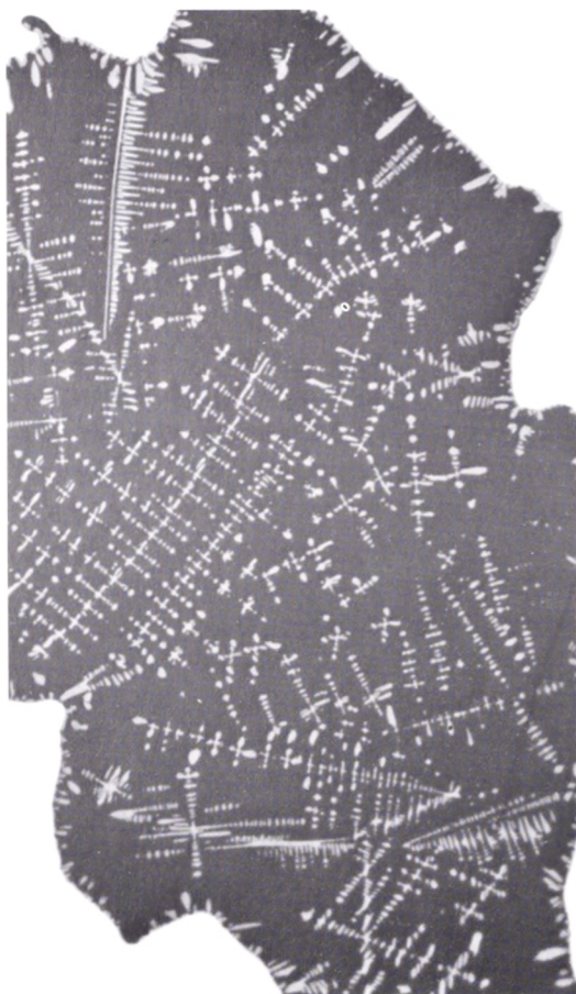
Fig. 12. Slagge med dendritter. 1 : 280. DTH fot.
