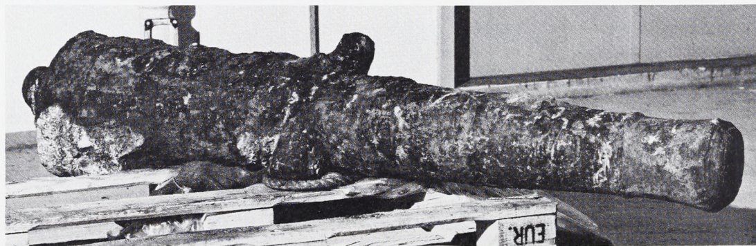
Fig. 3. Den delvist afrensede kanon. Bagest på løbet er efterladt en del af muslinge-»kappen« for at vise dennes tykkelse.
