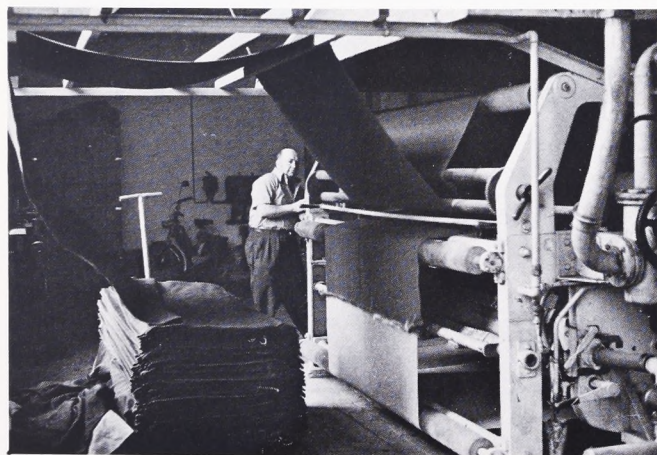
Fig. 7. Sømmensyede stykker klæde indtages i svidemaskine. Brandts Klædefabrik 1977.
