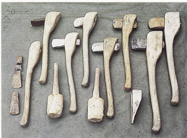
Fig. 5. Nogle af de anvendte redskaber. Til venstre to huløkser, hvoraf den ene er brudt to gange.
