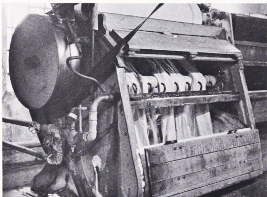
Fig. 2. Indsæbning af klæde i strangvaskemaskine. Brandts Klædefabrik 1977.
