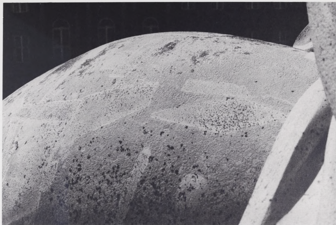
Fig. 17. Figuren viser nogle af de lapper, som det var nødvendigt at indføje i statuen af Frederik den Femte. Forskelle i metallens sammensætning har givet anledning til forskelle i patinerings og korrosion. Hestens bagparti højre side. K.H. fot.
