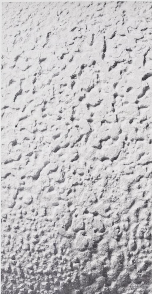
Fig. 19. Gipsafstøbning af statuens overflade på et af de opadvendte partier. Ætsningen afslører tydelig bronzens struktur. Afbildning 2 : 1. Afstøbning ved Karen Stemann Petersen. Niels Erik Jehrbo fot.
