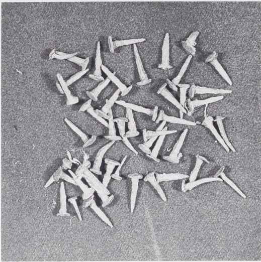
Fig. 4. De originale søm før og efter elektrolysebehandling.
