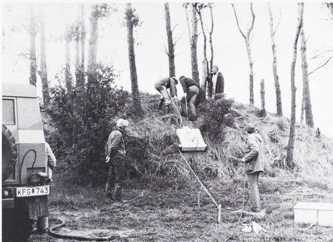
Fig. 10. Georadaropmåling over en høj på Himlingøje-gravpladsen. Antennen, monteret med hjul, trækkes manuelt over højen med kabelforbindelse til køretøjet med instrumenterne. MSJ fot. 1980.
