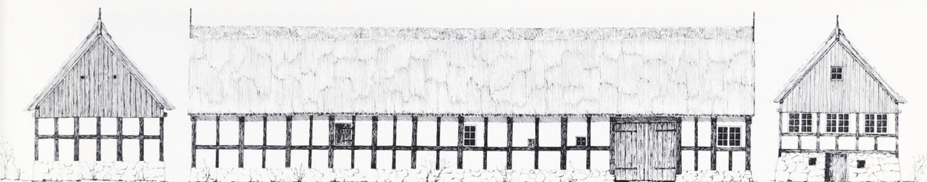
Fig. 6 og 7. Tegningerne på denne og foregående side viser plan og opstalter af gården på museet, 1:250. Tegningerne er udført til opmålingsværket »Bygninger på Frilandsmuseet«.
