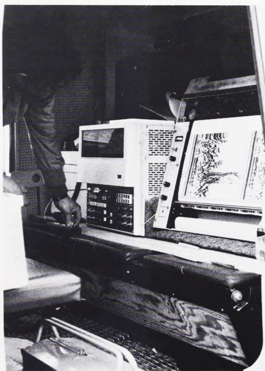
Fig. 11. Georadarens kontrolenhed, båndoptager og udtegningsdel, monteret i køretøj. Det udtegnede signal er refleks målt på højen fig. 10 og viser en nedgravning i højens centrum. E. Asmussen fot. 1980.
