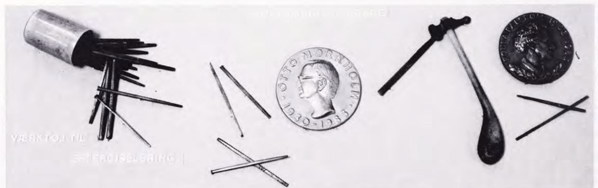
Fig. 5. Den støbte hovedmodel. Bronzestøberen benytter de to positive gipsmodeller ved fremstillingen af den ligeledes positive hovedmodel, der er støbt i to halvdele og derefter sammenloddet. Denne hovedmodel efterciseres af medailløren med særligt værktøj og er så klar til at bruge ved fremstillingen af sandformene. Disse må bygges op for hvert eksemplar af medaillen, man ønsker støbt, da de borthugges efter støbningen.
