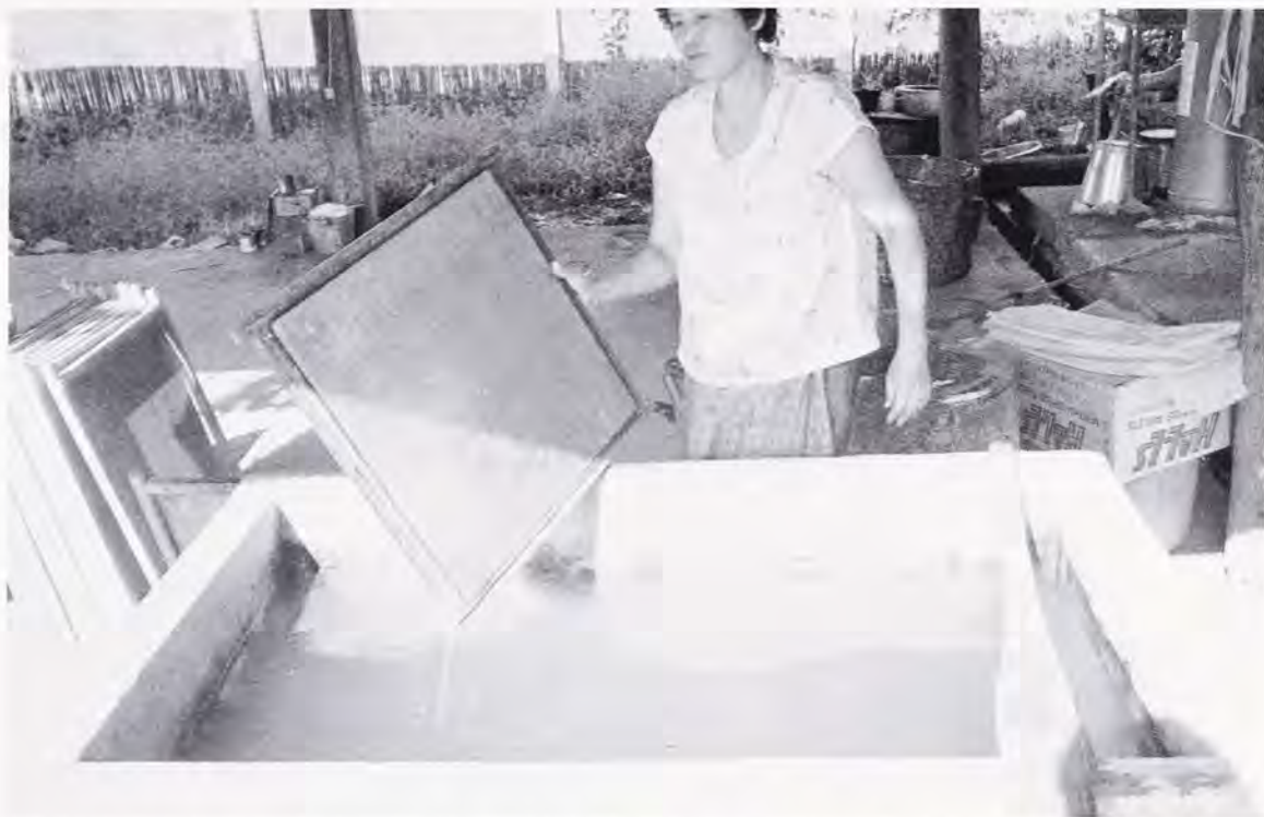
Fig. 13. Formen drejes rundt fire gange, så vandet kan løbe fra gennem den åbentvævede faste stofbund i hjørnerne. Derefter stilles formen til tørre i solen, hvor det tynde våde fiberlag på stoffet hurtigt tørrer, og det kan uden problemer løsnes fra formens stof.
