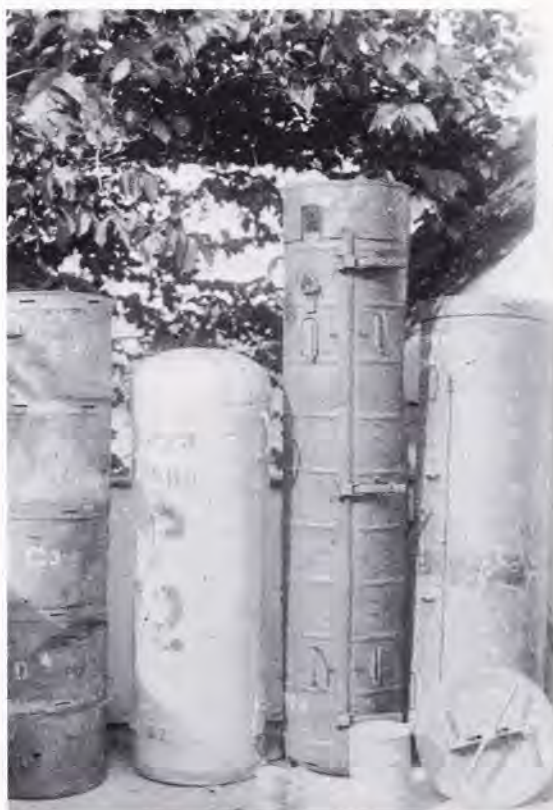
Fig. 5. Fire container-typer. Fra venstre en H-container, en »spand«, en C-container og en vandtæt beholder, beregnet til nedkastning i havet, hvorfra den kunne opsamles af lokale fiskere.
