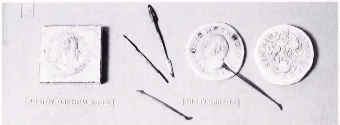
Fig. 4. Ved hjælp af de negative modeller støbes to positive gipsmodeller. Disse modeller gås efter af medailløren med specielt gipsværktøj og sendes derefter til bronzestøberen.
