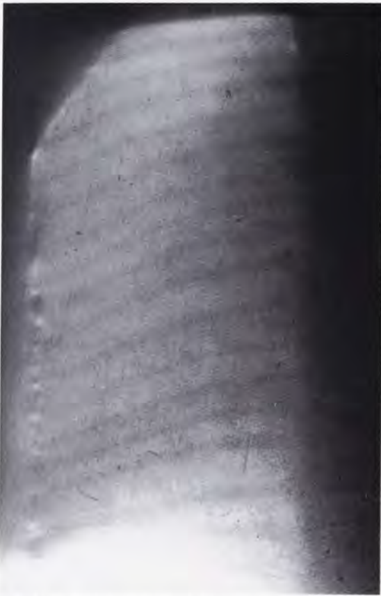
Fig. 10. Røntgentomografi af bemalet træstykke fra kirkestol. Metoden muliggør dendrokronologisk datering uden prøvetagning. (Opt. BAG).
