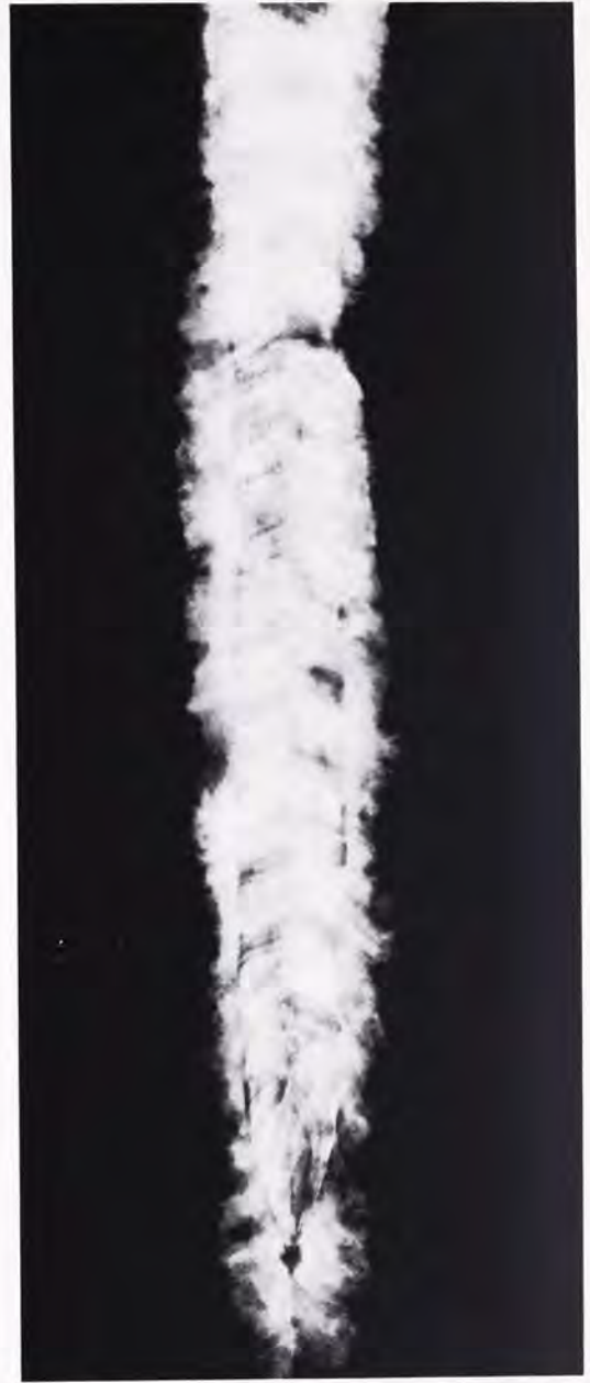
Fig. 6. Røntgenbillede af sværdklingen fra fig. 5. Det ses, at klingen er damaseret. (Opt. BAG).
