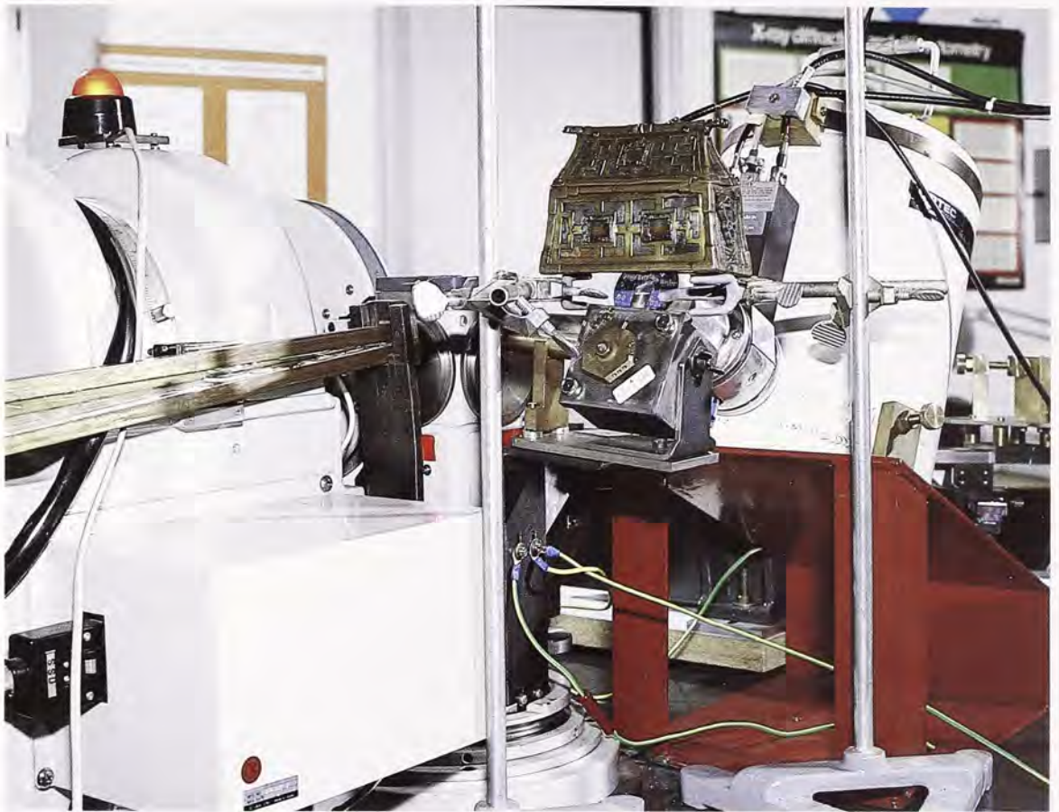
Fig. 21. Måleopstilling til energidispersiv røntgenfluorescensanalyse ved Laboratoriet for Teknisk Fysik III, Danmarks Tekniske Højskole. I midten ses det lodretstående røntgenrør. Røntgenstrålen ledes gennem et messingrør til et sekundært target og derfra gennem et mindre rør op mod genstanden, som skal analyseres. Den skråstillede detektor til højre er nedkølet til minus 196°C med flydende kvælstof, som befinder sig i den hvide cylinder. (Foto John Lee).
