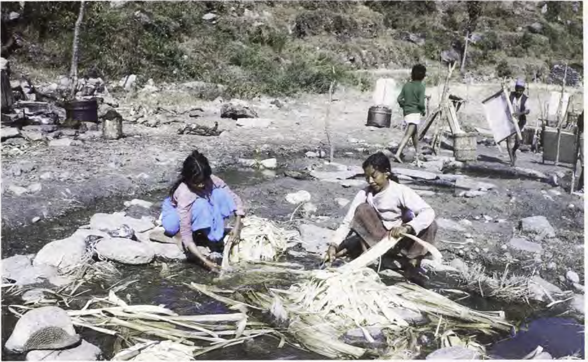
Fig. 2. Når barken skal bruges, lægges strimlerne i rindende vand et døgn, så det bliver muligt at adskille det mørke ydre barklag fra det indre hvide bastlag ved håndkraft. Hvis baststrimlerne ikke skylles grundigt inden kogningen, bliver papiret brunligt.
