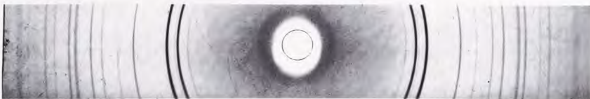
Fig. 22. Røntgendiffractionsoptagelse (Debye-Scherrer) af korrosionsprodukt fra Kristusfigur. Analysen viser tenorit (CuO). (Opt. Lab. for Tekn. Fysik III).
