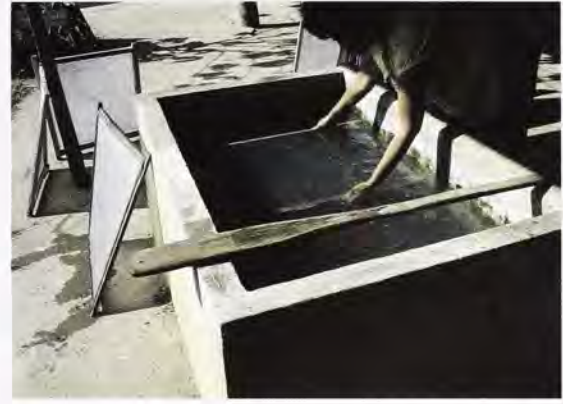
Fig. 11 og 12. I Thailand hælder man den færdige pulpmasse i et stort kar eller bøtte med vand, hvor fibre bliver pisket rundt, inden formen dyppes skråt ned og løftes op igen.
