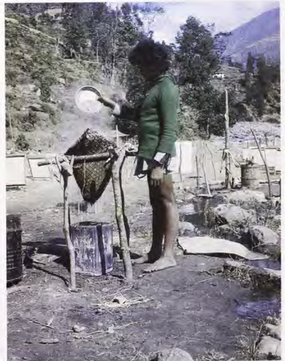
Fig. 3. Baststrimlerne koges i en askelud, som nedbryder støttevævet mellem fibrene. Asken kan enten hældes direkte i kogevandet, eller også kan vandet hældes gennem en portion aske i en bastkurv, hvor det langsomt kan sive igennem, mens askens salte opløses i vandet.
