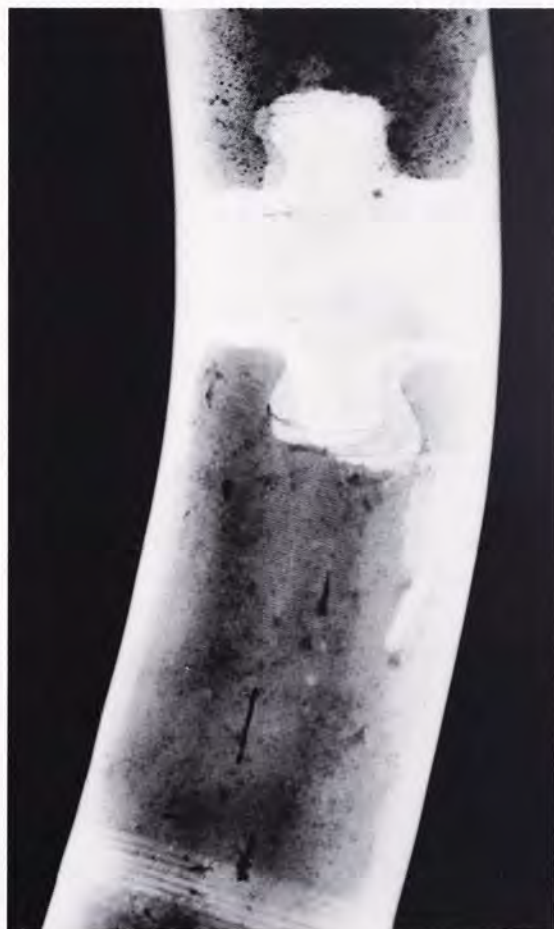
Fig. 14. Almindeligt røntgenbillede af et rørstykke fra en lur fundet ved Hallenslev. I midten ses en meandersamling, der fremtræder som en lys korslignende figur. (Opt. BAG).
