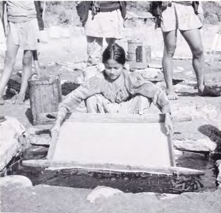
Fig. 8. Den tynde piskede fibersuppe fordeles med en øse mellem fingrene eller gennem en si ned i formen, og denne løftes skråt op, mens vandet løber fra gennem det åbentvævede stof. Fibrene ligger tilbage i en våd filt på stoffet, og formen sættes til tørre i sol og vind. Når fiberlaget er helt tørt, kan det færdige ark løsnes, og det er ikke nødvendigt med en efterfølgende presning eller udglatning.
