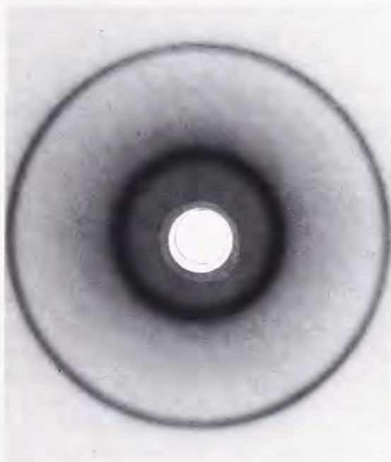
Fig. 23. Diffractionsmønster (Laue) fra en præget sølv-mønt. (Opt. Lab. for Tekn. Fysik III).
