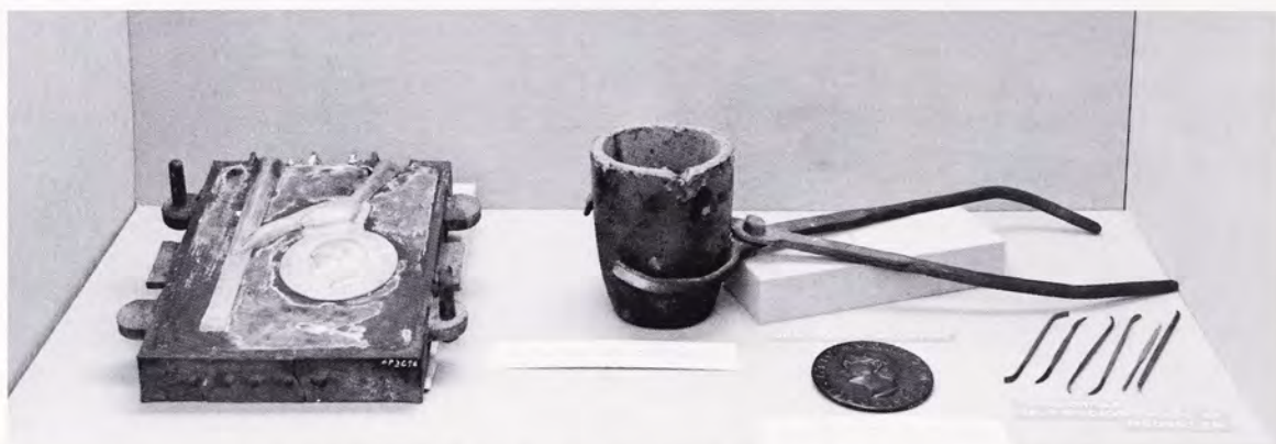
Fig. 13. Efterbehandling. Støbekanalerne skæres af medaillerne, som derefter sandblæses og poleres. Derpå kommer de igen i medaillørens hænder for en sidste eftercislering, inden de patineres. Under eftercisleringen hviler den nystøbte medaille på en opvarmet begkugle, anbragt i en skål. Begkuglen afgiver varme til bronzen, der derved bliver lettere at bearbejde. Til visse støbninger kan en mindre digel anvendes ved hjælp af en gribetang. Digelet er lavet af grafit og carborundum.
