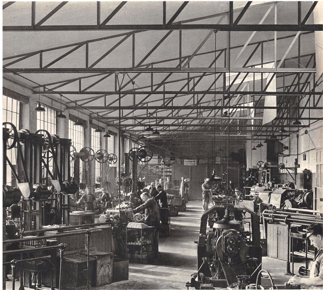
„Automatafdelingen“ for Massefabrikation af Bolte, Metrikker, Bøsninger etc.
