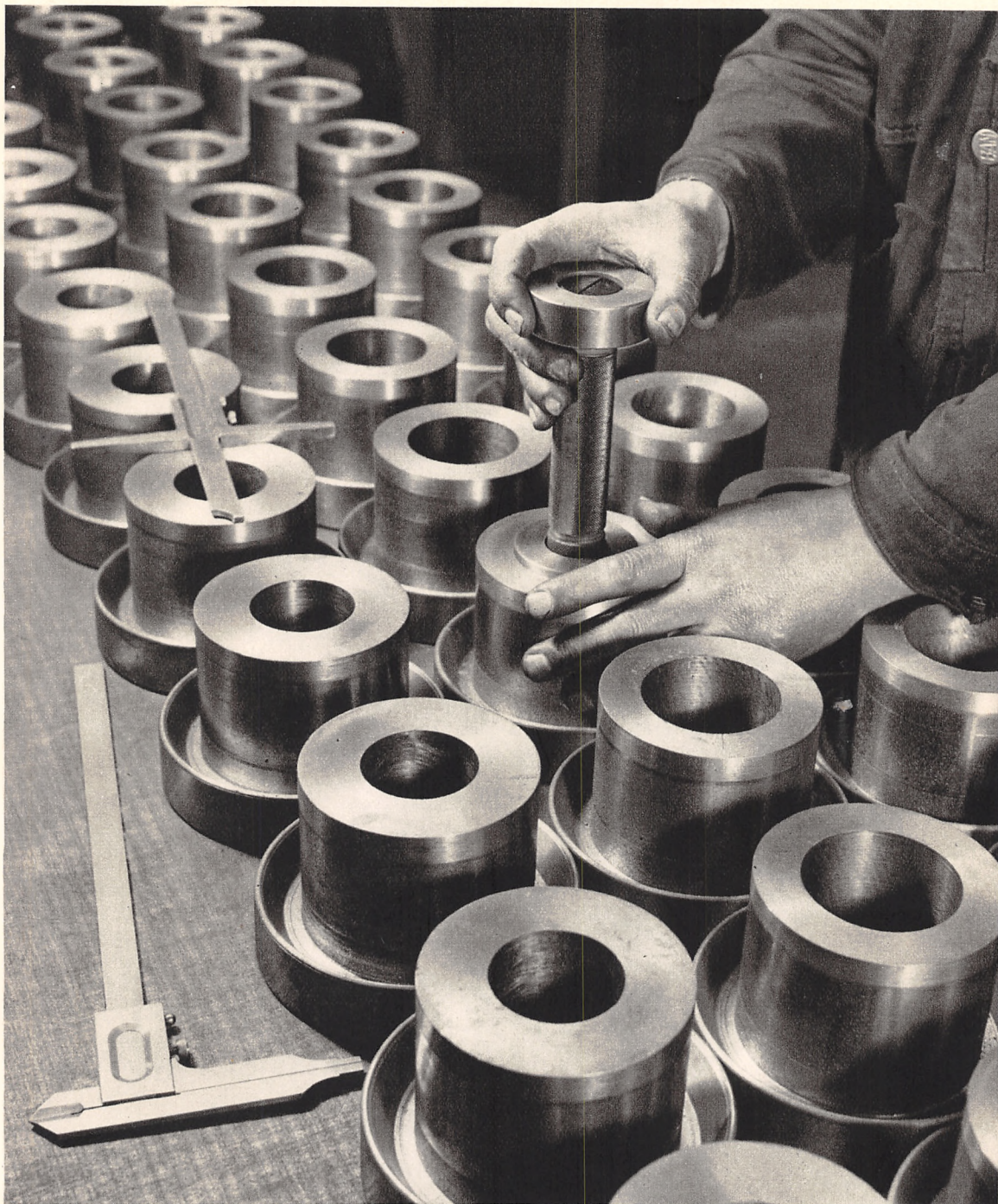
Efterkontrol med Tolerancedorn paa hundrededels Millimeters Nøjagtighed.
