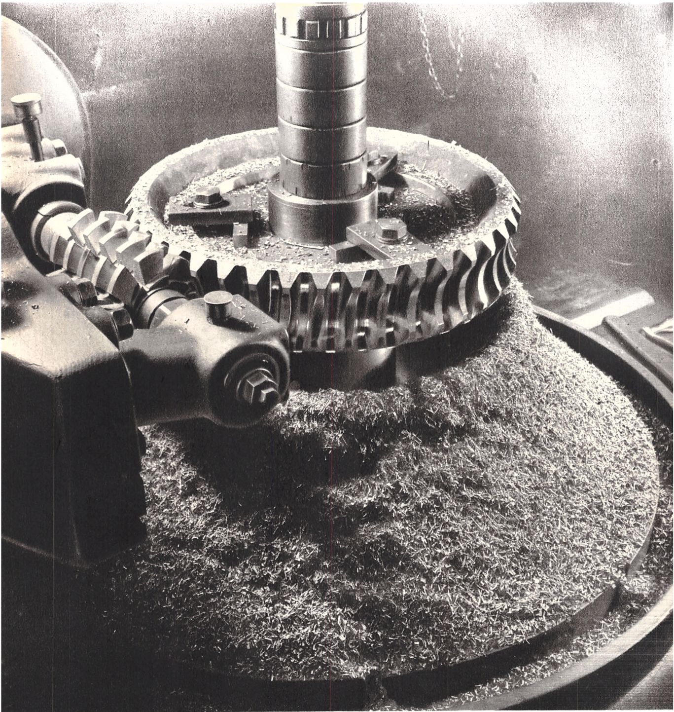
Fræsning af en Snekkekrans.
