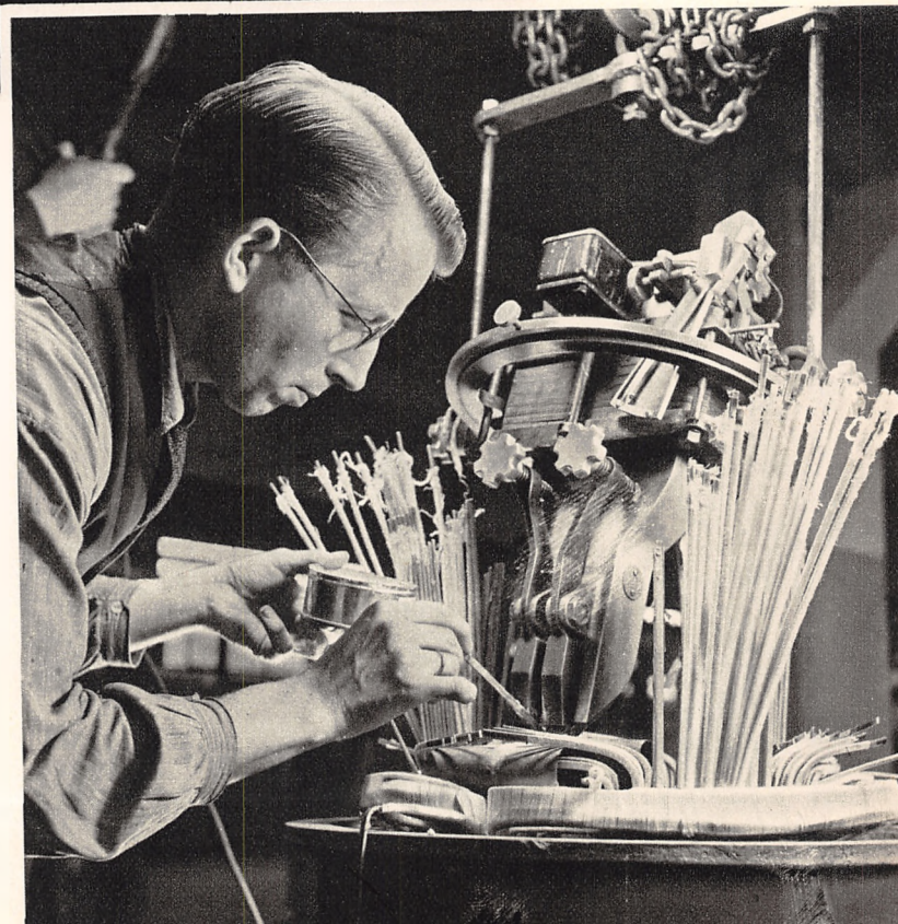
Statorspolerne forbindes ved elektrisk Svejsning.
