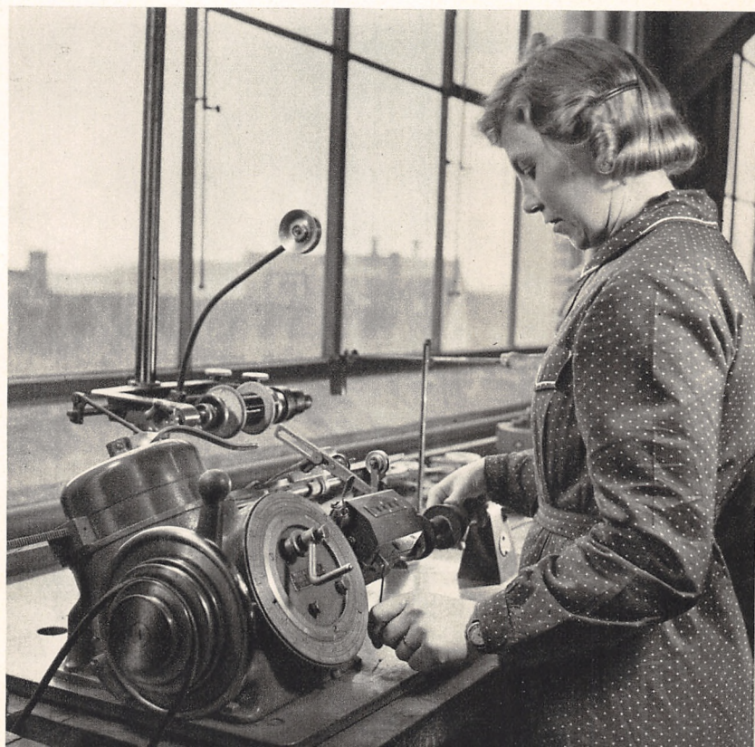
Fremstilling af en Magnetspole.
