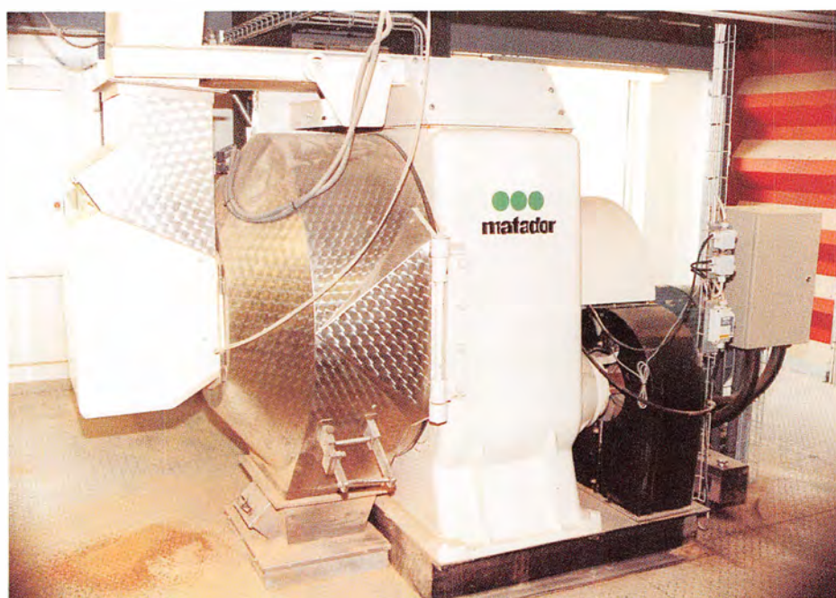
En feedprocessor på Tjelefabrikken. Ved at varme foderet op til mindst 81 grader sørger feedprocessoren for at udrydde alle salmonellabakterier.
