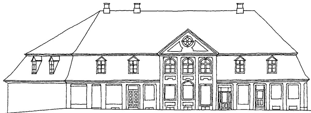
Hovedgaden 40, facade og stueplan af den tidligere kro »Holland«s hovedbygning ca. 1924 (efter en opmåling før ombygningen i 1927). Ca. 1:300.
