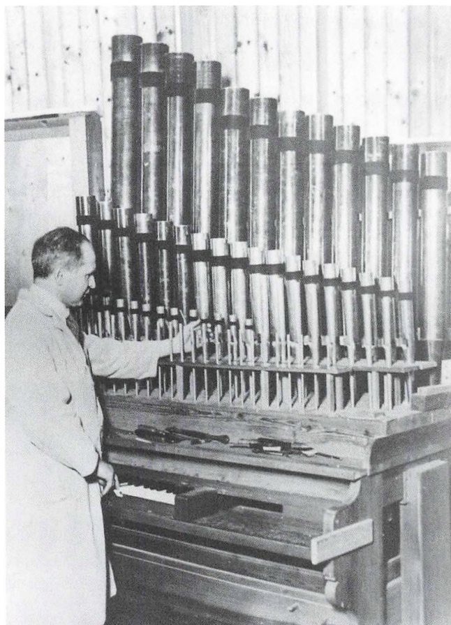
Orgelbygger Theodor Frobenius ved »intonereladen«, i færd med at intonere og stemme en »gedakt«-stemme. Fotografiet viser orgelbygmesteren i sit sædvanemæssige arbejdstøj: den hvide kittel. Over spillebordet ligger det værktøj, han arbejder med: bl.a. et stemmehorn. Fot. Hartz, Lyngby 1948. Th. Frobenius & Sønners arkiv
