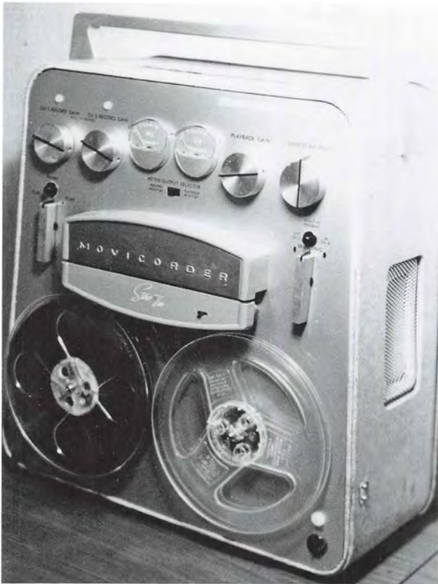
Movicorder A2 båndoptager, der anvendtes af The Go-Getters som ekkomaskine.
