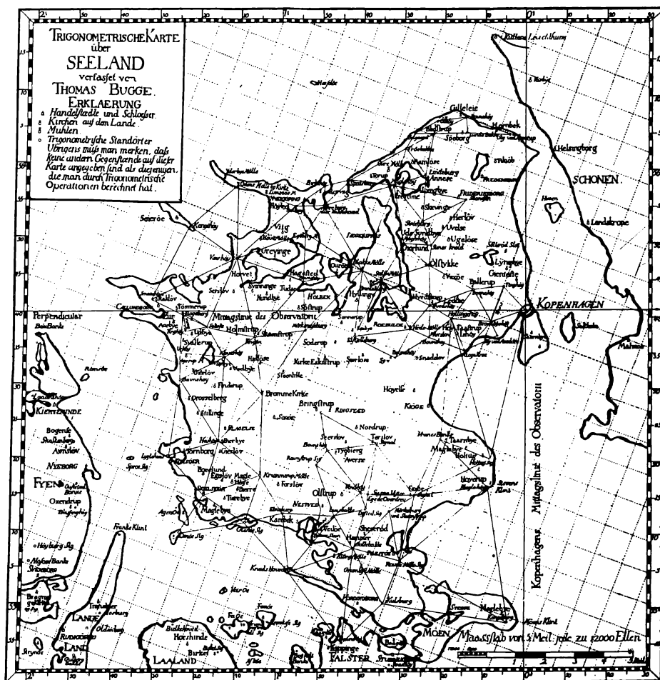
Reproduktion af Bugges trigonometriske kort fra den tyske udgave af bogen. Det for en del tydelige kvadratnet med siden 1 mil eller 12000 alen og rettet efter hovedbasislinien havde været udstukket i terrainet til brug for den topografiske opmåling.
