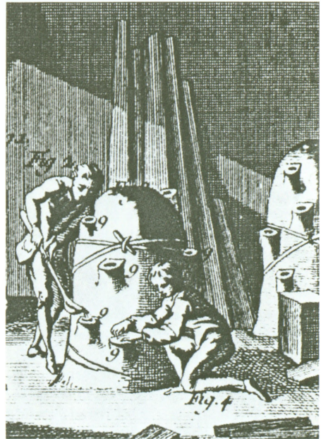
En formindsket model med støbekanaler til en rytterstatue af Ludvig 14. af Martin van den Bogaert, kaldet Desjardins (1637-94). Udført for at angive anbringelsen af de kanaler, hvorigennem den flydende bronze skal løbe ved anvendelse af cire perdue-teknikken. Under støbningen er form og kanaler omgivet af en kappe, eventuelt af ler, som det fremgår af et stik i Encyclopédie ou Dictionnaire raisonné des sciences, des arts et des métiers, udkommet fra 1751 til 1780.
