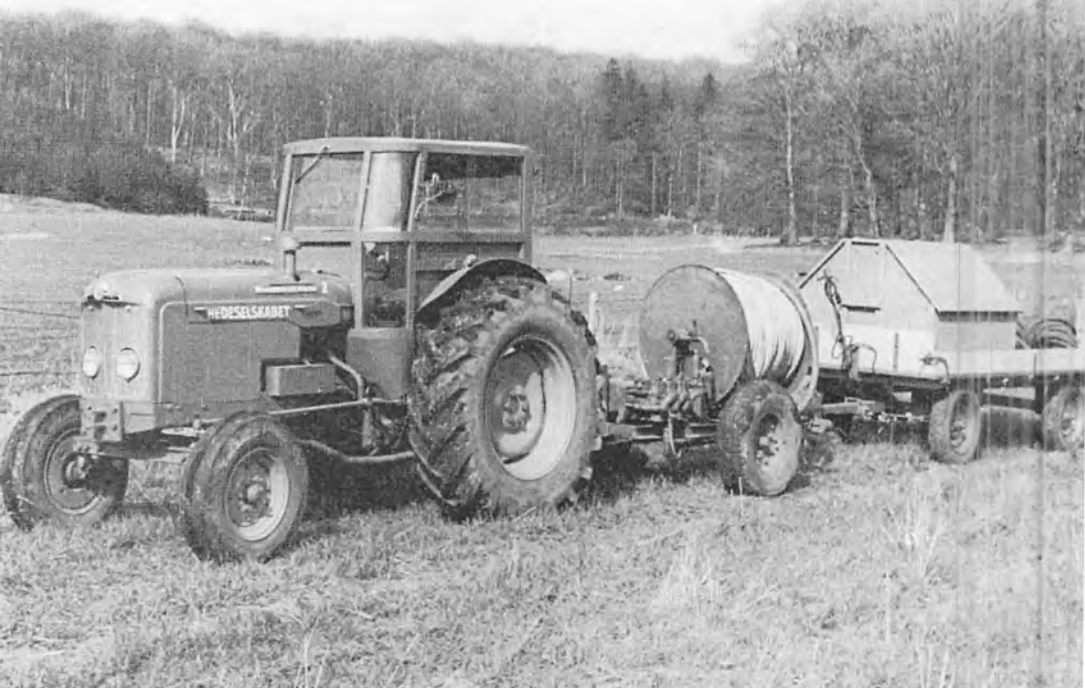
Drænrensemaskinen rykker ud. Maskinen arbejder under 80 atmosfærers tryk.
