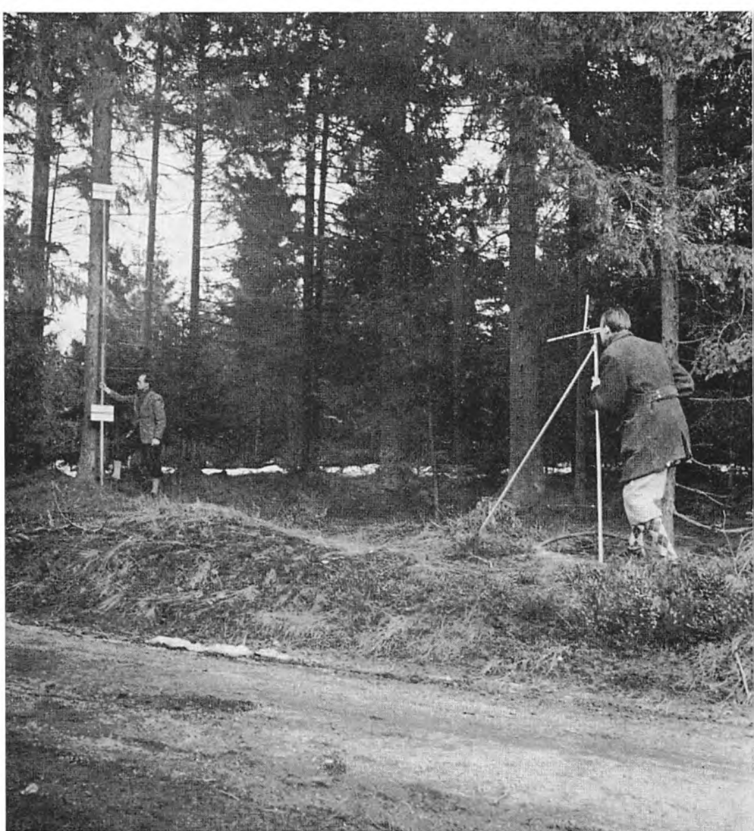
Opmåling i Neckelmanns plantage ved Viborg 1952. Ved instrumentet - Løvengreens højdemåler - skovtaksator G. West-Nielsen.
