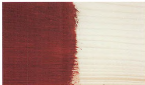
Fig. 6. Et stykke af et ubehandlet bræt bestrøget med limfarve med farvepigment fremstillet af okker fra Skårup. (foto Ewald Skov Jensen)
