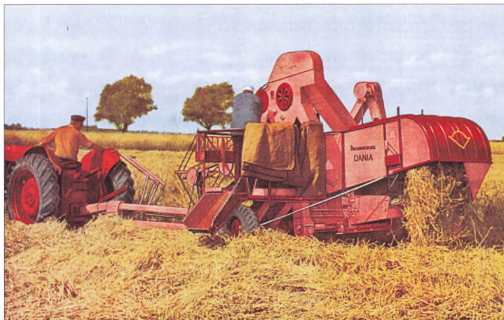
"Dronningborg" i Randers fik den første danskproducerede mejetærsker afprøvet på Bygholm i 1955. En bugseret 5-fods sækkemaskine med en kapacitet på 20–30 tdr. korn i timen.
