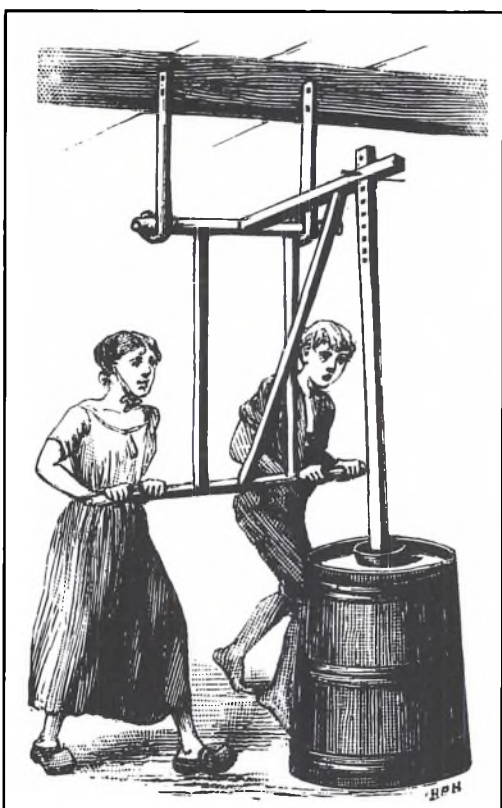
Fig. 32. Gengivelse af træsnit af stampe-kærne til at skubbe, B. Bøggild: Mælkeribruget i Danmark, 2. udg. s. 414, 1860-1875.
