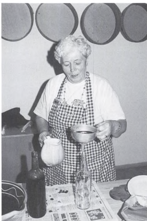
På syltedagen den 11. oktober kunne vi bl.a. vise den »selvfyldende« tragt fra Voss-fabrikken, som havde været efterlyst i Jyllands-Posten. Tuden er forsynet med en ventil, der lukker, når tragten løftes op af flasken. Marie Hansen viste hvordan den blev brugt.
