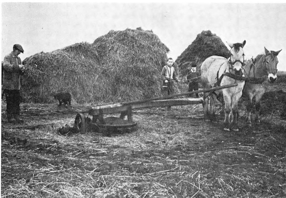
Måske var dette den sidste hestegang i drift her i Danmark. Tv. ejeren, husmand Johannes Christensen, Svenstrup, Søby sogn, Gern brd. Ved tømmerne dennes barnebarn, Karl Johan Mikkelsen. Hestegangen var på ejendommen ved overtagelsen 1927. Den leverede trækraft til tærskemaskine, bakkelsesmaskine og kværn indtil 1966. Fotografiet er fra efteråret 1964.
