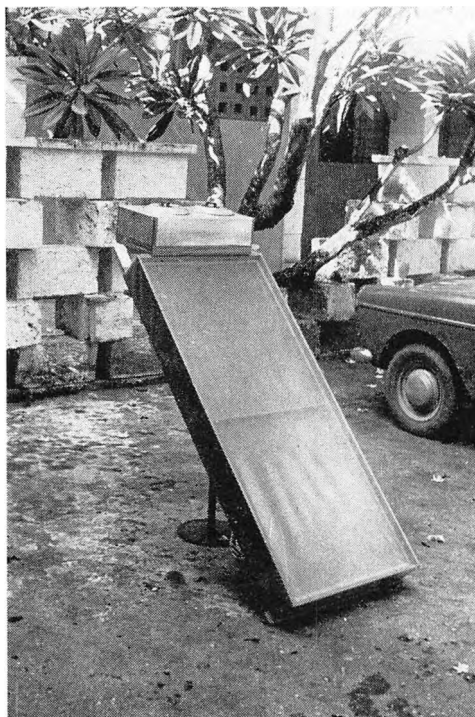
Fig. 4. Simpelt »solkomfur«. Vandfyldt u-rør på sortmalet plade med isolering under og to lag plastic over. Vandet bringes af solen til fordampning, hvorved f. eks. kartofler dampkoges på ca. en times tid. Skulle man komme for sent til spising, vil den isolerede »grydekasse« fungere nøjagtigt som en »bøkkasse« og holde maden varm i længere tid. Billedet er taget på Brace Research Institutes eksperimental-station på Barbados.
