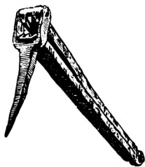
Kalmjern til støbning af blyprosser.
