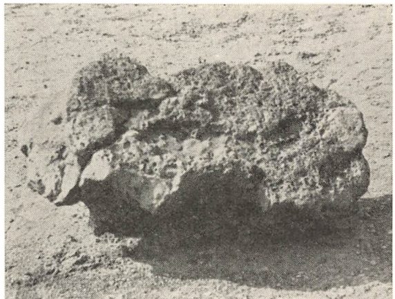
Slaggeblok fra Jernudvindingspladsen. Vægt ca. 100 kg. Man ser tydeligt, hvor det udsmolte Jern er afhugget.
