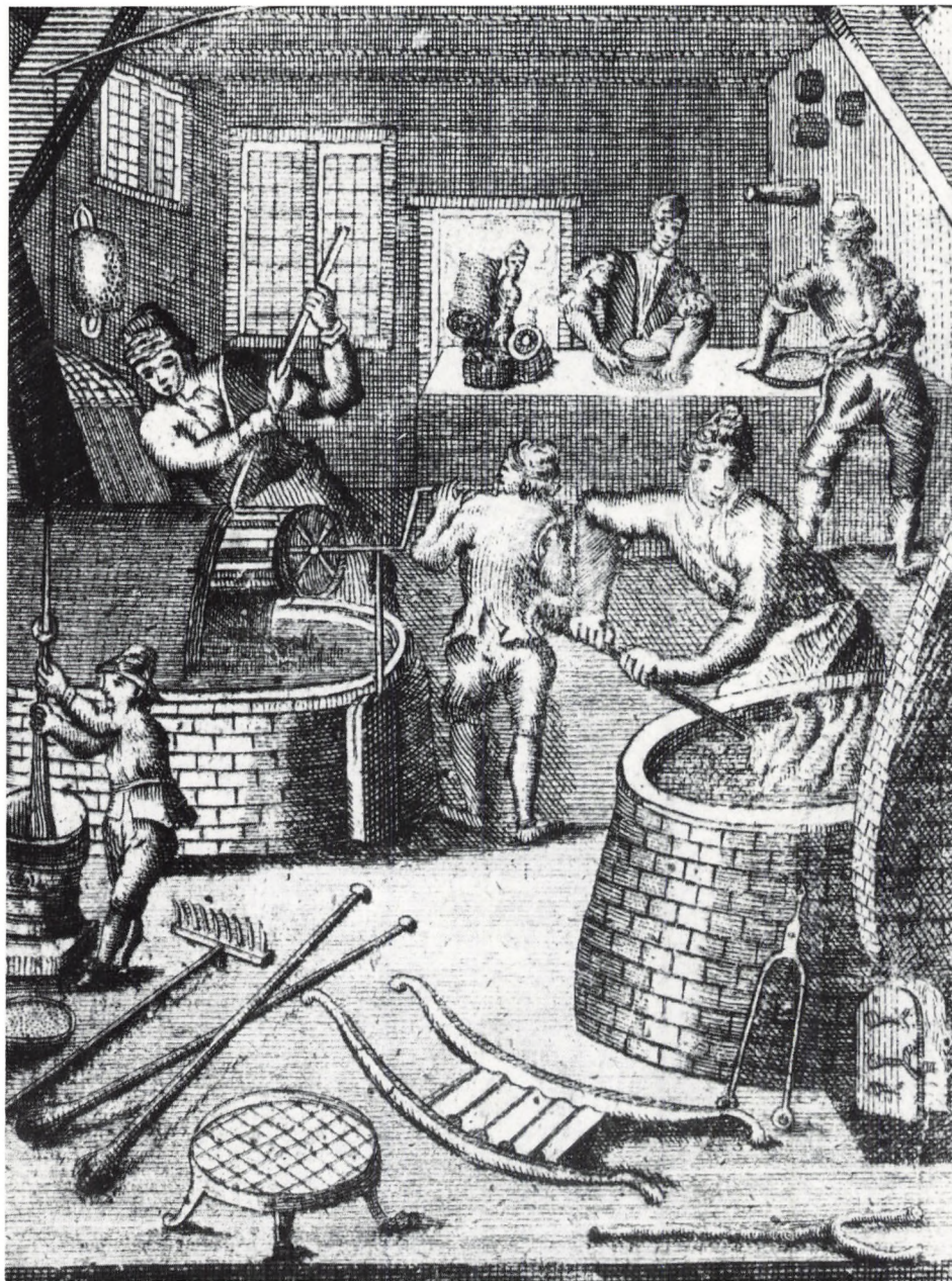
Fig. 9. Kobberstik fra 1768, som viser et farveri med indmurede farvekedler og arbejdsredskaber. I forgrunden ligger farverens arbejdsredskaber: rive, træstokke, en jernrist og træbør. Til venstre støder lærlingen eller medhjælperen indigo. Til højre ses en farver, der holder farveemnet i bevægelse med en træstok, og til venstre for ham bliver et helt stykke tekstil farvet over en trævalse. Bagest i stikket tilberedes farvestoffer.
