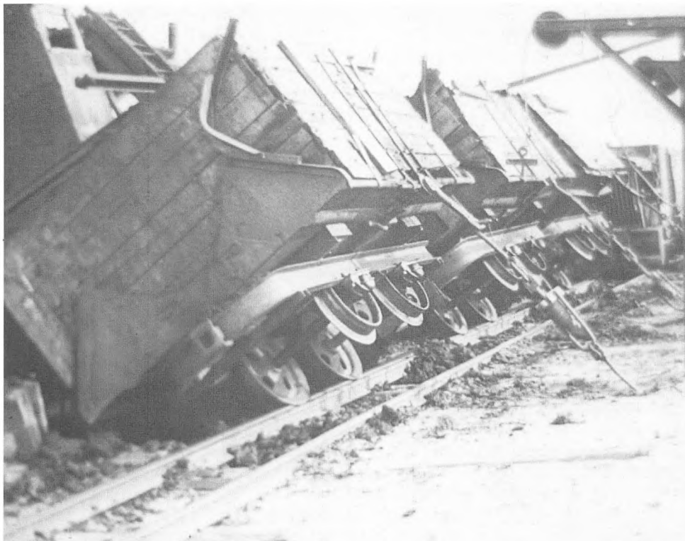
Vognene tippes over i ælteværket ved hjælp af et anlæg. Foto: Privat.
