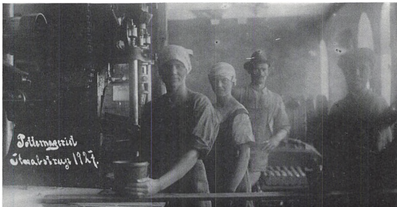
Fig. 3. Et glimt fra pottemageriet 1927, hvor man ser den store jernform, hvori leret presseses af det ovenfor værende stempel, som det omtales i artiklen.
