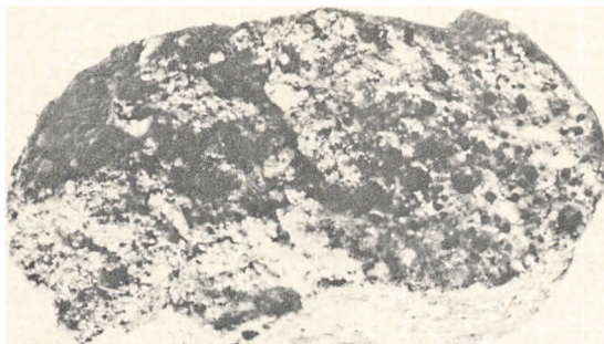
Fig. 5. Stykke af smeltingerand, brændt så hårdt, at leret næsten er blevet glasagtigt.
