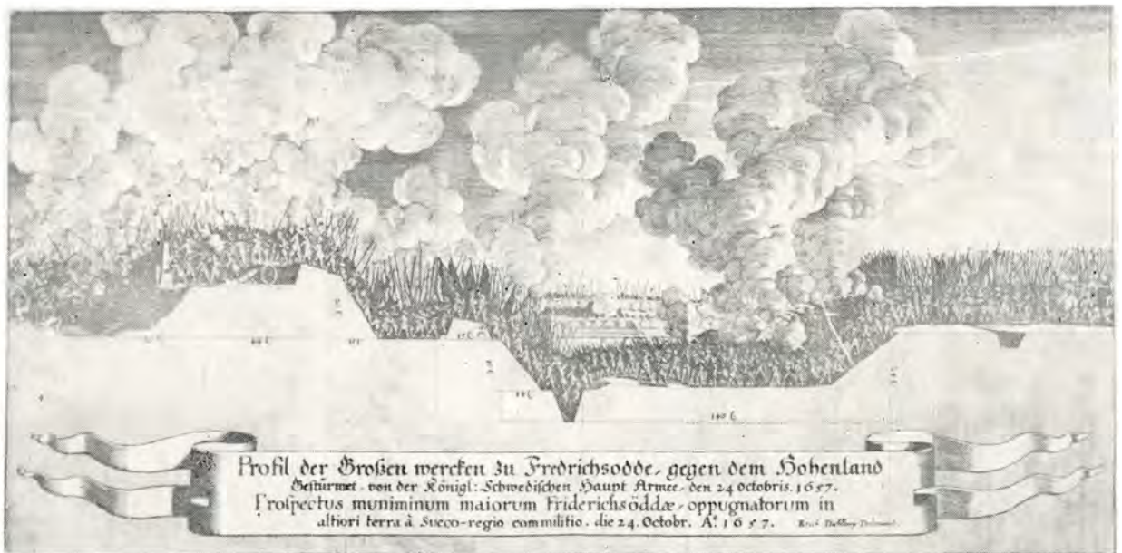
Nr. 16. Svenskernes storm på Frederiksodde den 24. oktober 1657. Tegningen viser et snit gennem voldanlæg, voldgrav samt glacis. Fra venstre ses hovedvolden. Foran denne en lavere forvold, faussebraie, derefter voldgravens indre side, eskarpen. I den brede, tørre voldgrav en mindre, dybere grav, anlagt for at forhindre overrumpling. Fra graven fører kontreskarpen op til fortærrænet, glaciset. I dette ses en afvandingsgrøft.
